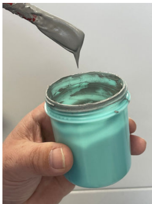
Bild 10: Lotpaste im Anliefergebinde nach dem Auf-rühren von Hand
