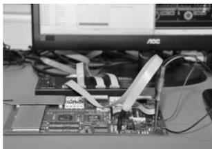
Zusätzliche elektrische Baugruppenprüfung mit Boundary Scan (BS)
